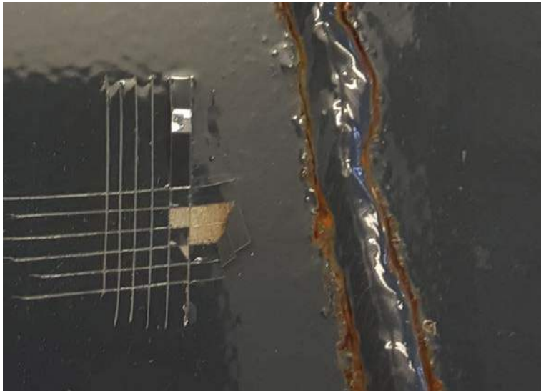
Abbildung 14: Projekt C5-Prüfblech mit nicht vorbereiteter Schweißnaht nach bereits 168 h neutralem Salzsprühstest.
