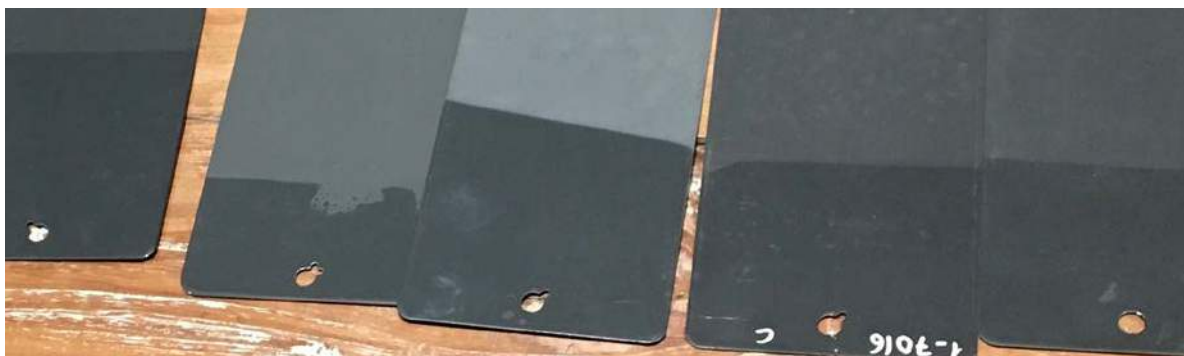
Abbildung 6: Feuchteschäden an pulverbeschichteten Aluminiumplatten: Durch die Einlagerung von Feuchtigkeit kommt es zu sichtbaren Farbveränderungen
