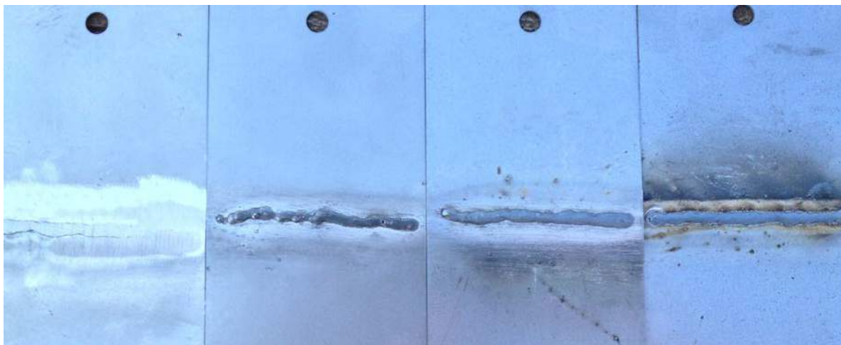
Abbildung 12: Schweißnähte in absteigendem Reinigungsgrad
