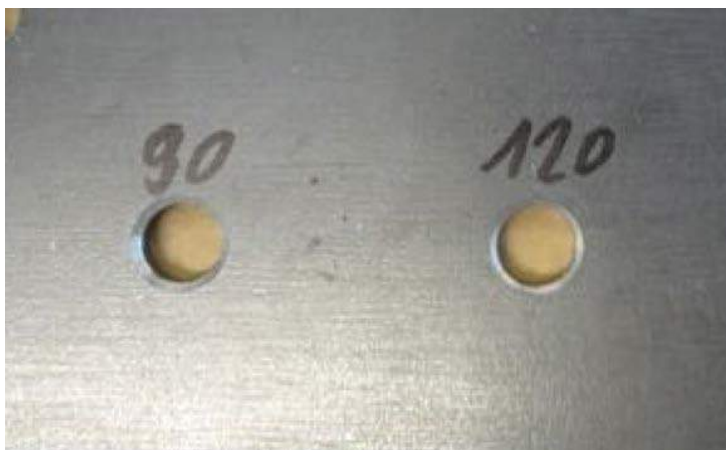
Abbildung 11: Spezialteil des QIB Projektes C5 mit verschiedenen vorbereiteten Bohrungen, 90° gesenkt, 120° gesenkt.
