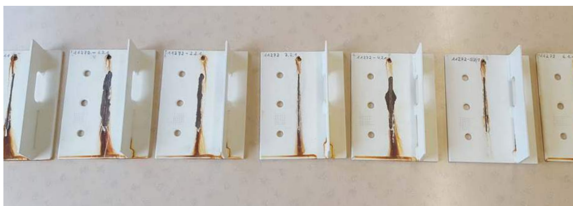
Abbildung 19: Übersicht über Ergebnisse des QIB Projektes C5 – Prüfkörper nach 1440h neutralem Salzsprühnebeltest von verschiedenen Beschichtungsbetrieben
